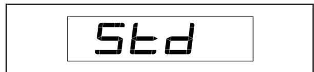
**Displayprüfung** – Dieser Bildschirm ist für Wartungstechniker bestimmt, damit sie feststellen können, ob das Display richtig funktioniert.
